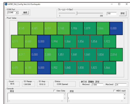
サンプルアプリケーションで ToF センサーの各ピクセルの状態が確認できます。
